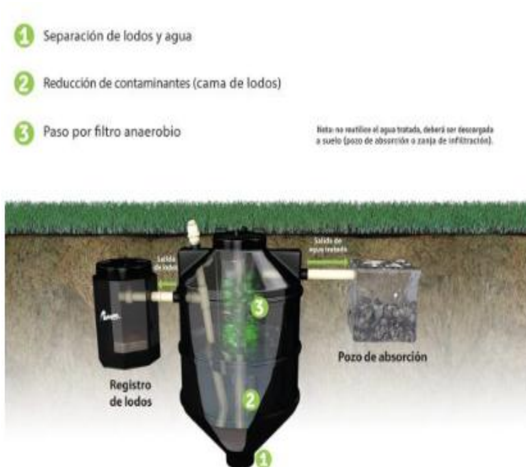
Figura 6. Funcionamiento del Biodigestor autolimpiable. Fuente: http://rotoplas.com
